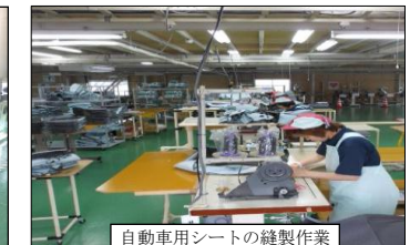
自動車用シートの縫製作業
